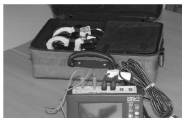
Photo 1 : Analyseur d'énergie électrique de marque HIOKI 9625
